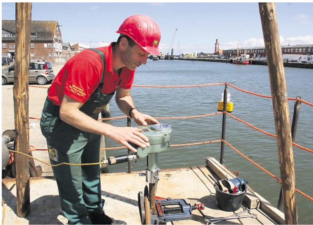
Hauke Harms bei der Feldflügelsondierung im Alten Fischereihafen. Mit dem Spezialgerät misst der Brunnenbauer die Festigkeit des Hafenschlicks vor der Kaikante an der gesperrten Nordseekai. Die Daten fließen in das Gutachten ein, das NPorts bis zum Herbst veröffentlichen will. Foto: Sassen
